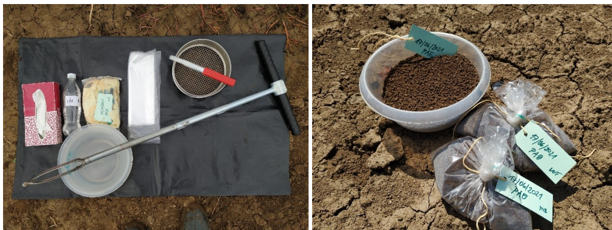
Obrázek 3. Sada nářadí k odběru půdního vzorku, odebrané vzorky
