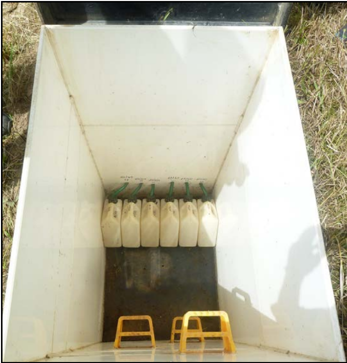
Pohled do sběrače - lyzimetrické šachty, nádoby na záchyt perkolátu v horizontech 40, 60, 80 cm
