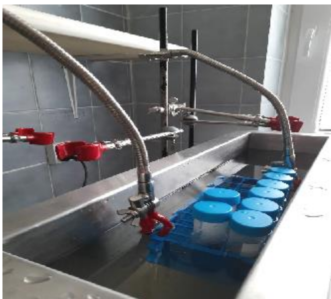
Obr. 7. Sonifikace vzorku v ultrazvukové lázni při 40 °C.
