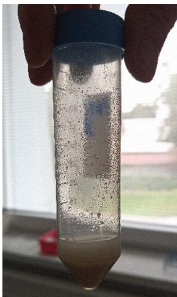
Obr. 14. Ulpívání vzorku na stěnách centrifugační zkumavky.
