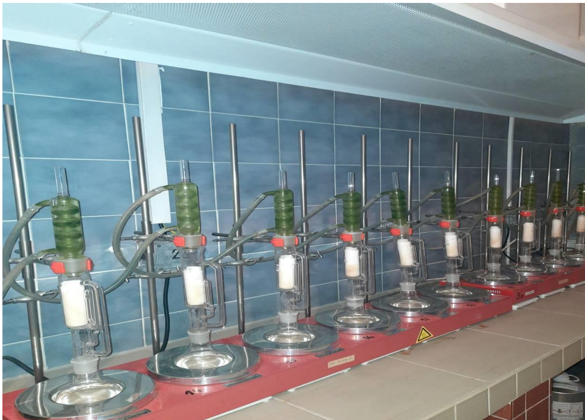
Obr. 1. Extrakce vzorku chloroformem.
