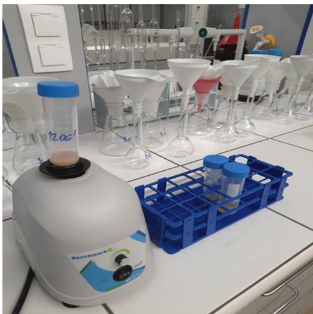
Obr. 5. Odtučnění vzorku na vortexu.
