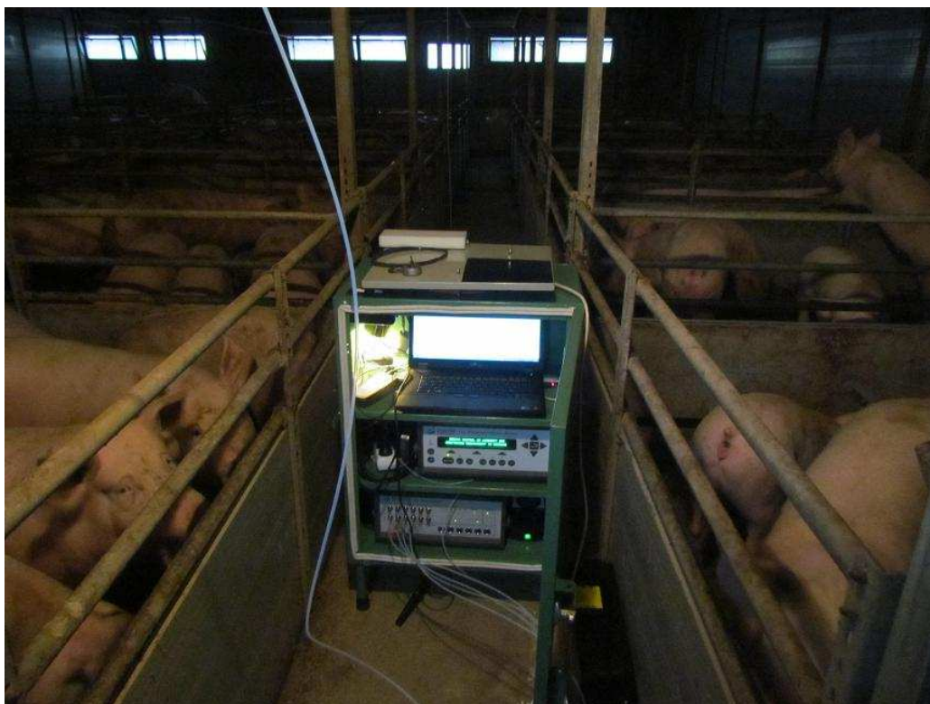
Obr.č.3 – Sestava měřícího přístroje INNOVA 1412 v prachotěsném boxu
