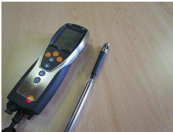
Obr.č.7 - Přístroj Testo 435 s vrtulovou sondou, Zdroj: Autoři
