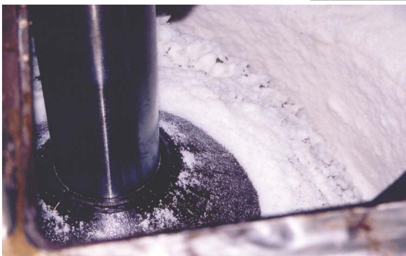
Odstředování hotového cukru
